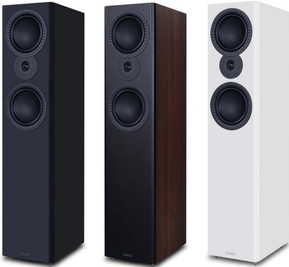
Mission LX-5 MkII – это вторая по старшинству напольная модель в Серии LX, оснащенная двумя 165-мм (6.5") НЧ/СЧ-динамиками с композитным волоконным диффузором и 25-мм (1.0") купольным микрофибрзовым твитером.
