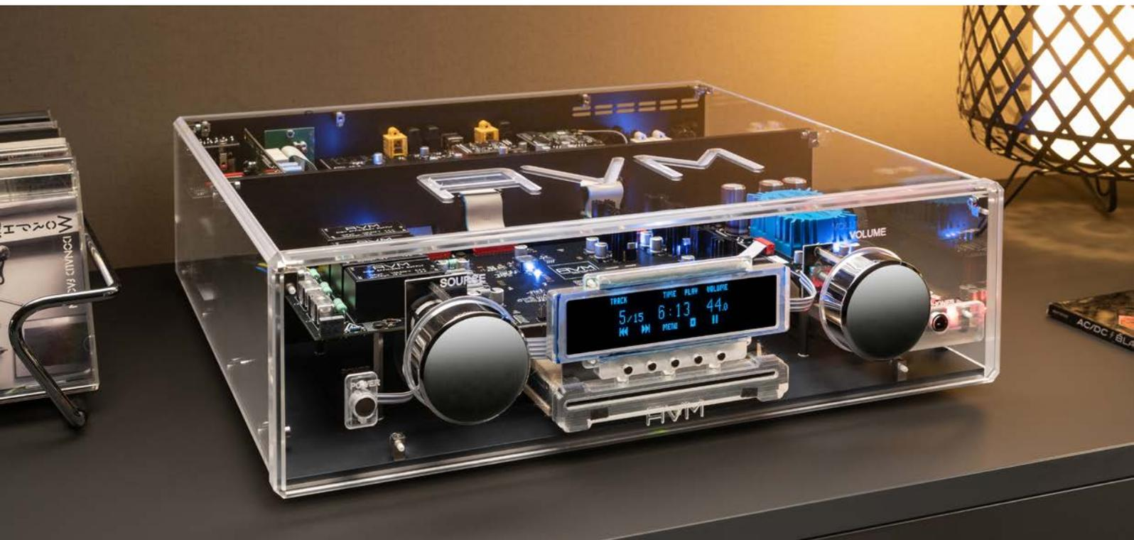
преобразования, благодаря чему CS 8.3 принимает все распространенные разрешения PCM и DSD. Секция предусилителя оснащена лампами (более дешевая модель CS 6.3 использует исключительно транзисторы), что имеет веские эстетические причины, поскольку явно точный и нейтрально звучащий усилитель мощности класса D от датской компании Pascal Audio должен приобрести более деликатный ламповый характер».
